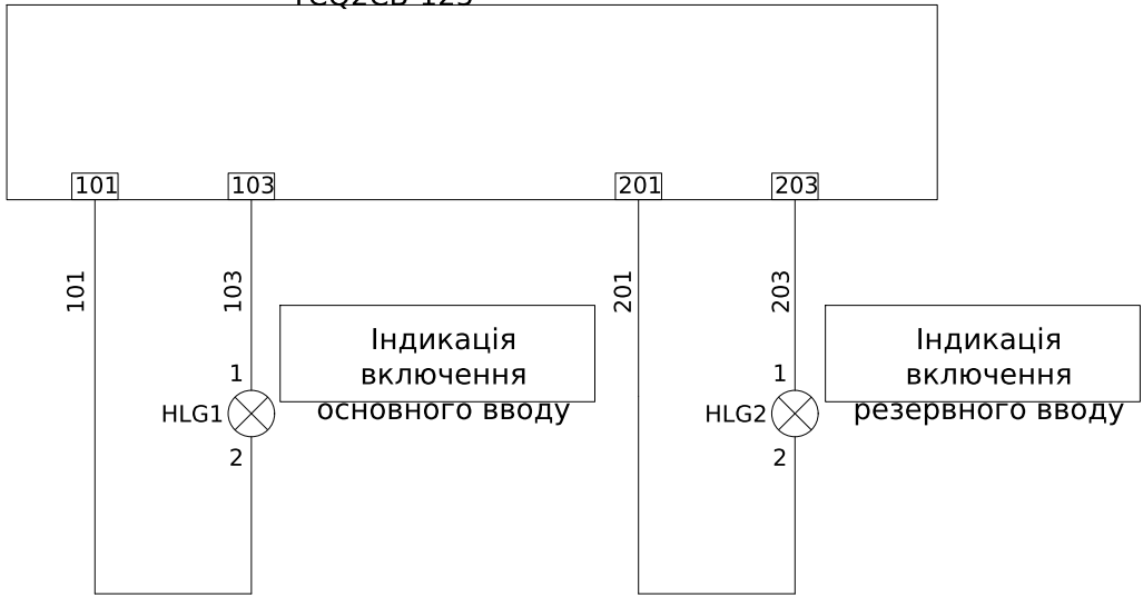
Схема живлення ланцюгів індикації положення Автоматичний ввід резерву YCQ2CB-125
